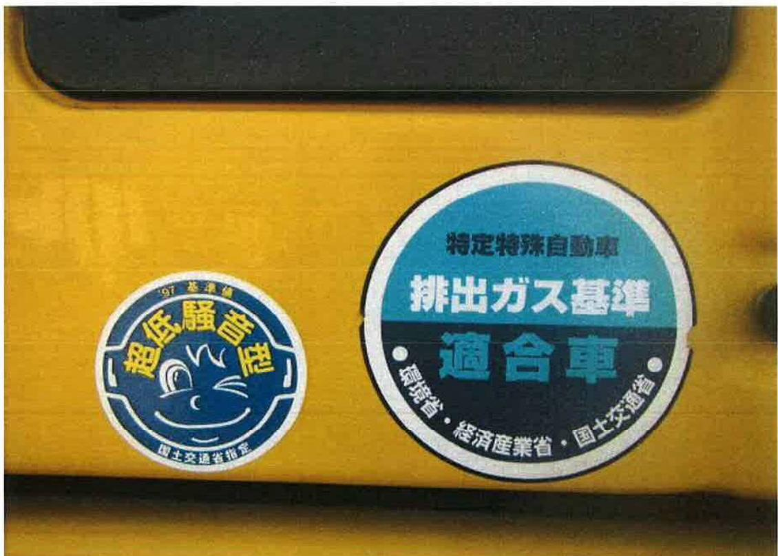
排出ガス・振動・騒音対策型建設機械 確認資料
